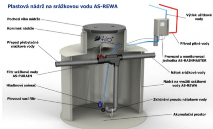
Obrázok 13 Nádrž na zadržiavanie zrážkovej vody, retenčná nádrž
