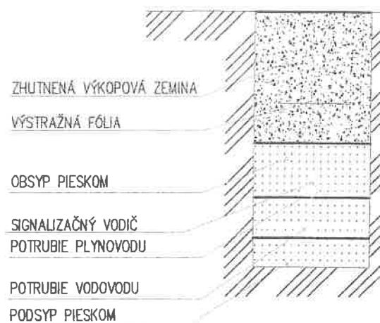
ZVISLÉ KRÍŽOVANIE PRIPOJOVACIEHO PLYNOVODU A VODOVODNÉHO POTRUBIA VO VÝKPE (ČSN/STN 73 6005)
