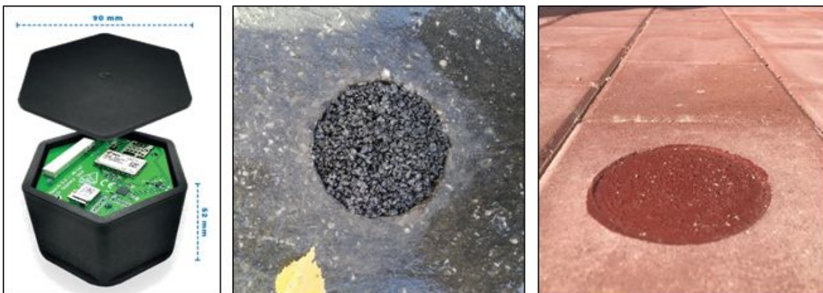
Náhľad do vnútra senzoru – plošný čip, pod ktorým je ukrytá batéria a senzor obsadenosti umiestnený pod vozovkou s povrchovou úpravou
